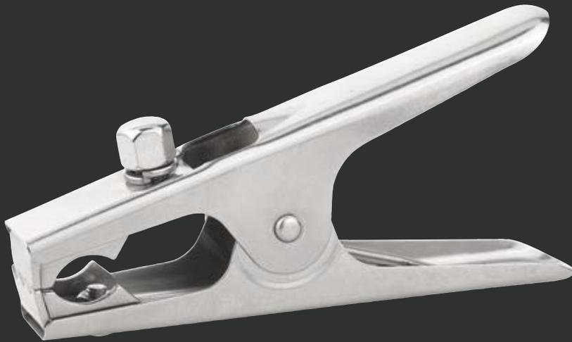
Die Erdungszange Q.Crodile X PL115-1 eignet sich zur Erdung von allen unlackierten Anlagenteilen und flexiblen ableitfähigen Materialien. Zu den typischen Anwendungsbereichen zählt die Erdung von unlackierten Gebinden, FIBCs sowie Rohren und Gebindehenkeln. Die verbauten Dreizack-Zähne sorgen für einen festen Halt ohne das Material zu zerstören. Zusätzlich können sämtliche Rundmaterialien mit einem Durchmesser von > 20 mm sicher geerdet werden.
